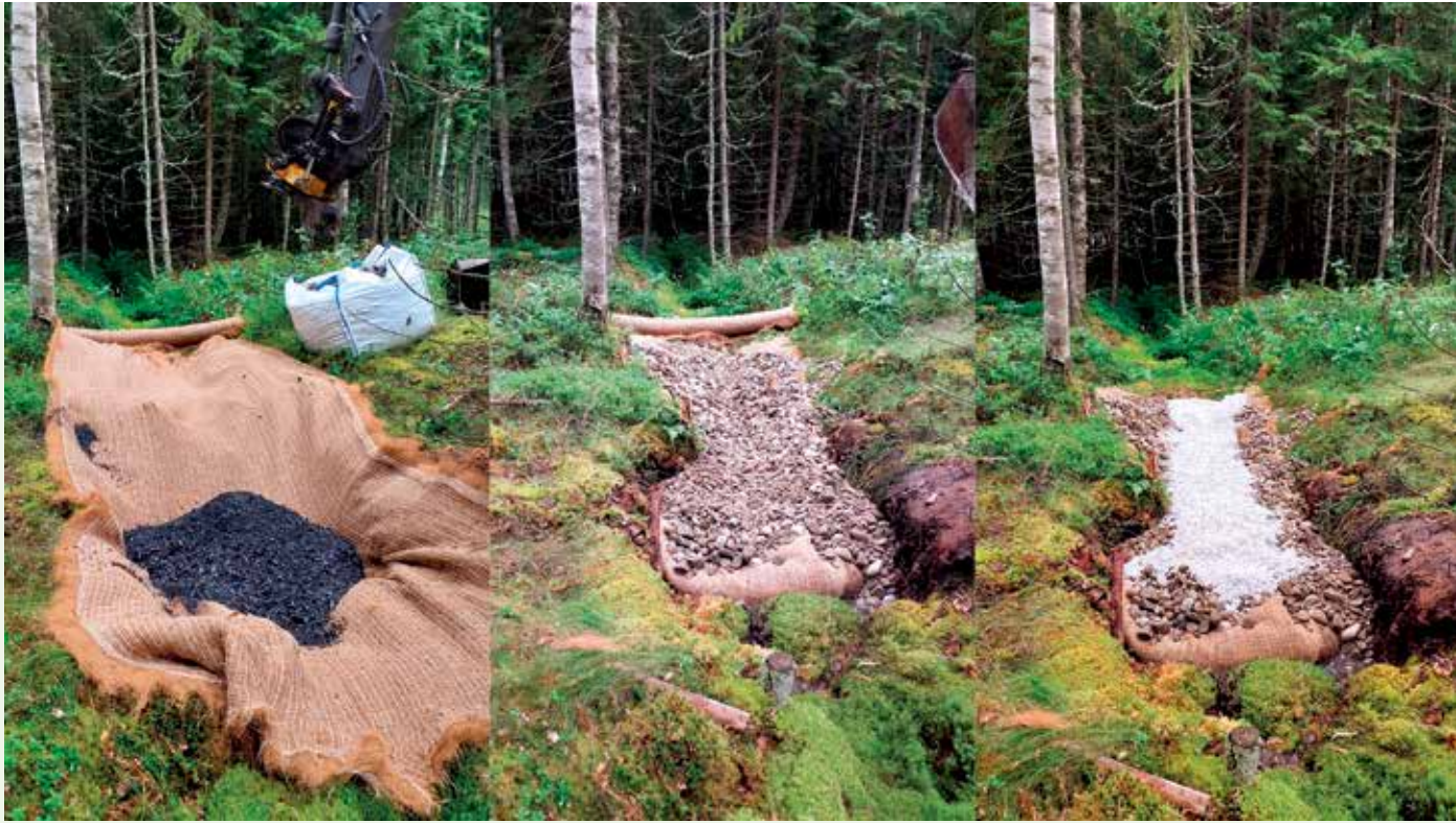
LUVY kokeilee, miten biohiili ja kalkkikivi vaikuttavat ojitetun suometsän valumavesiin. Biohiili, sora ja kalkkikivi on lisätty eroosiomaton avulla metsäojaan suodattamaan vettä. (Kuvat: LUVY / Mikko Melasniemi)
