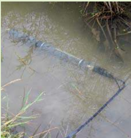
Automaattinen mittausanturi valvoo veden laatua pelto-ojassa. Kuva: Paula Muukkonen
