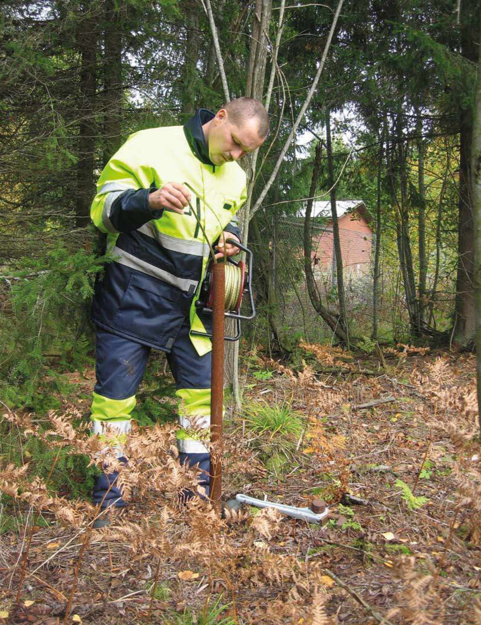
Kenttäestari Seppo Sundström mittaa pohjaveden pinnankorkeutta. Kuva: Aki Mettinen
