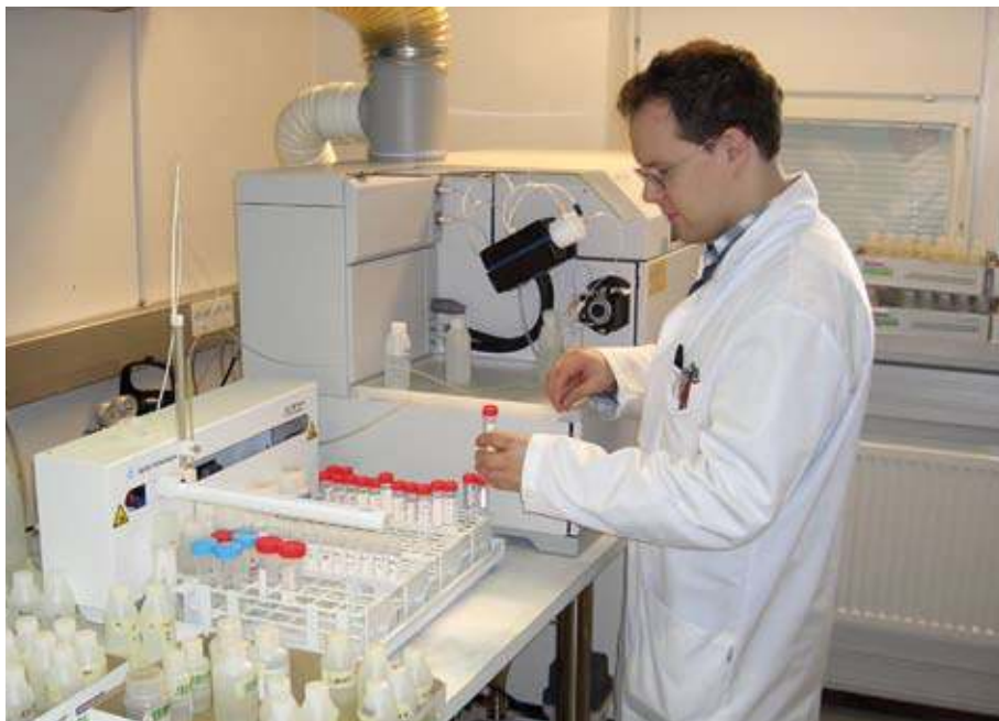
Pienten metallipitoisuuksien määrittäminen onnistuu kemisti Mikko Suomelalta ICP-MS-laitteella. Kuva: Kokemäenjoen vesistön vesiensuojeluyhdistys ry.
