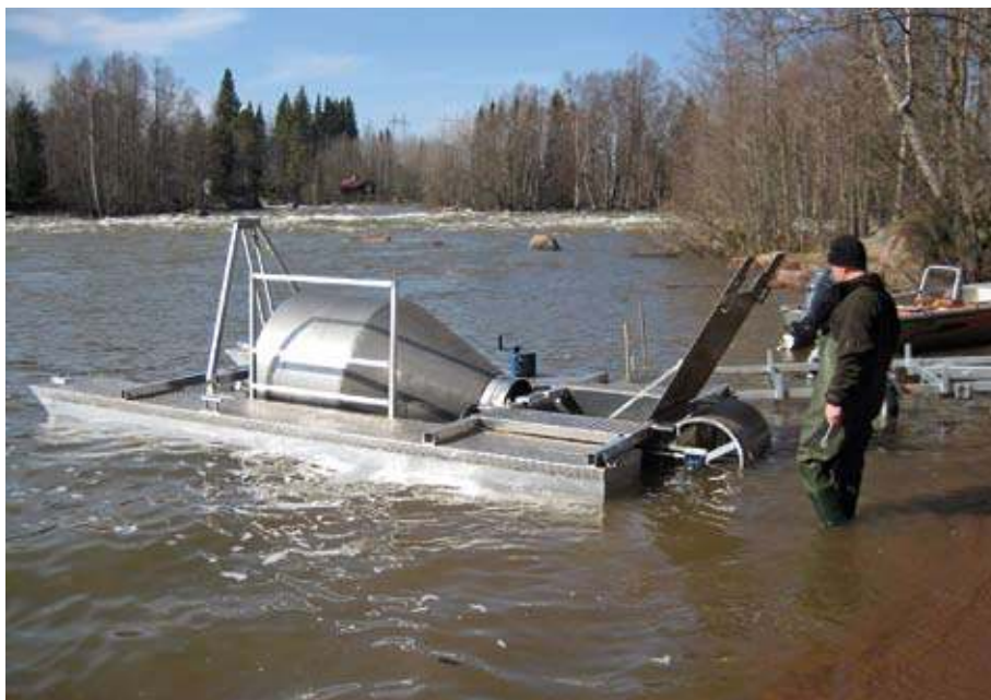
Kymijoella lohikalojen vaelluspoikasia tutkitaan vaelluspoikas- eli smolttiruuvikootaan rannassa ja sitä lähdetään viemään pyyntipaikalle Pernoon koskien alapuolelle. Taustalla kuohuvat Pernoonkosket sijaitsevat Kotkan pohjoispuolella. Kuva: Kymijoen vesi ja ympäristö ry.
