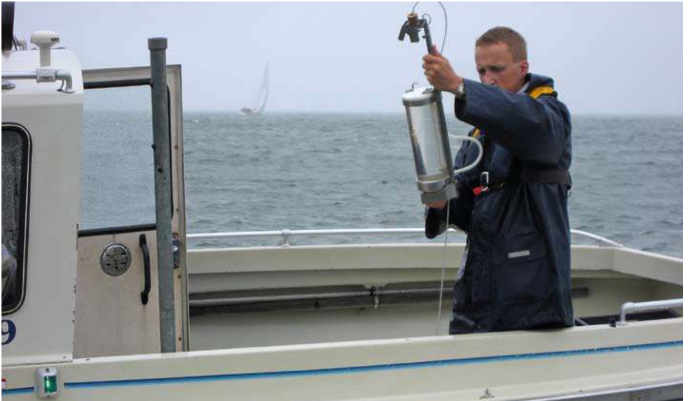
Iktyonomi Jani Hannula tarkistaa veden lämpötilan Limnos-noutimen näytteestä Kustavin pohjoispuolella Seksmiilarin merialueella. Kuva: Roger Aapola
