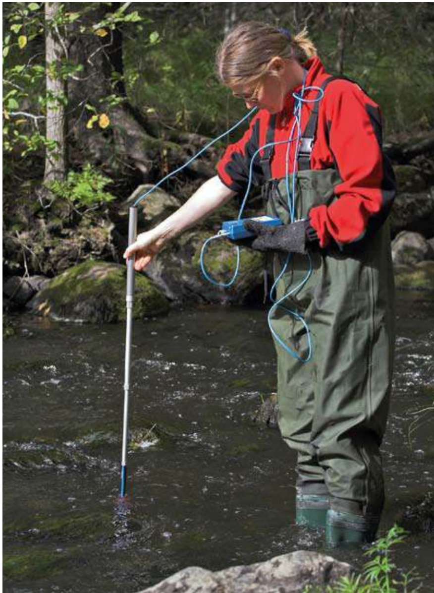
Tutkija Heli Vahtera mittaa veden virtausnopeutta minisiivikolla Keravanjoen latvoilla. Kuva: Pasi Valkama
