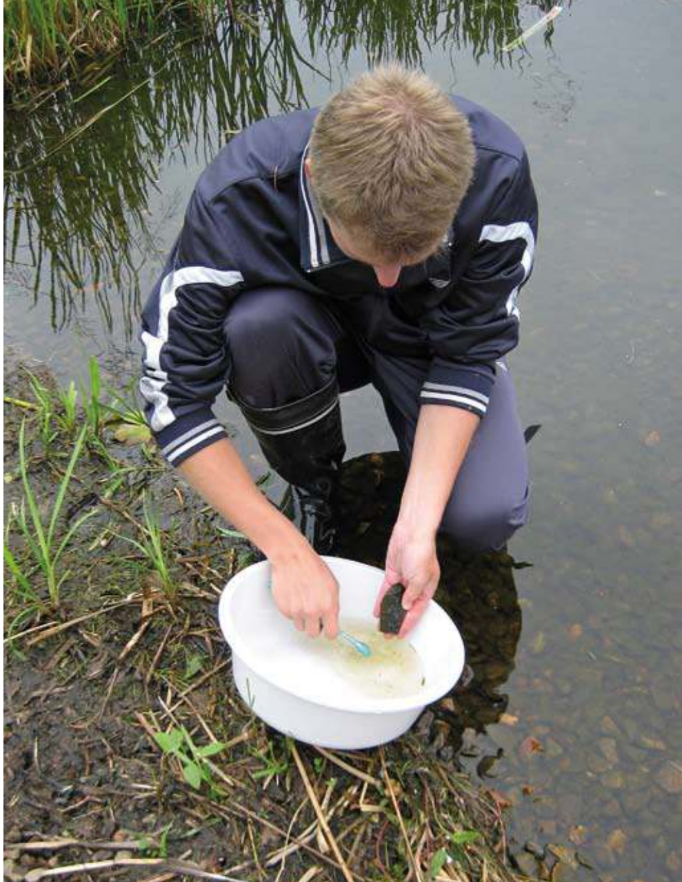
Kivien pinnoilla kasvavaa piilevää raaputetaan hammasharjalla. Menetelmä on korvannut perinteistä keinoalustamenetelmää viime vuosina. Kuva: Kymijoen vesi ja ympäristö ry.
