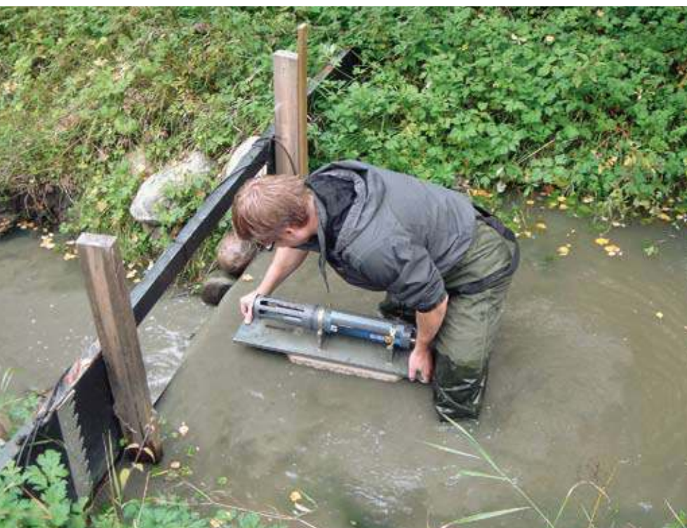
Tutkija Pasi Valkama asentaa YSI:n mitta-anturia tutkimuspuroon. Anturi mittaa muun muassa veden sameutta, happipitoisuutta ja sähkönjohtavuutta. Kuva: Virpi Pajunen
