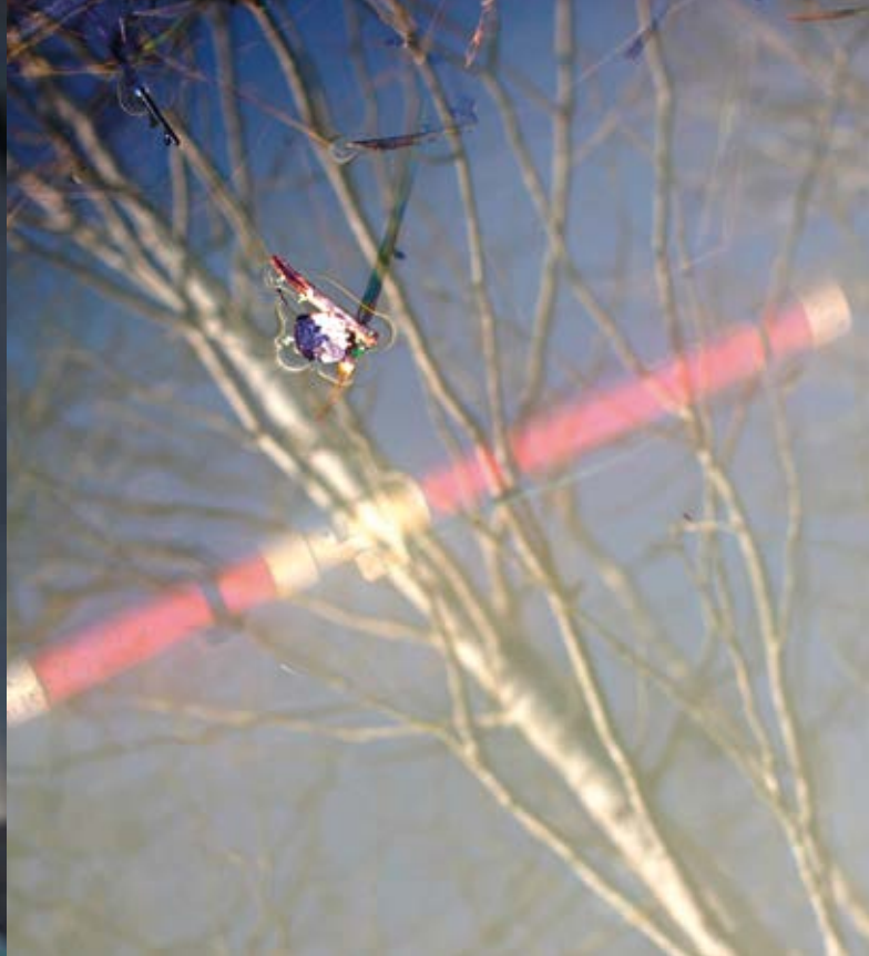
Scanin anturilla voidaan mitata sameutta ja nitraattityypen pitoisuutta. Vaatimuksena on kuitenkin laadukas, laboratoriossa tuotettu kalibrointidata. Kuva: Pasi Valkama
