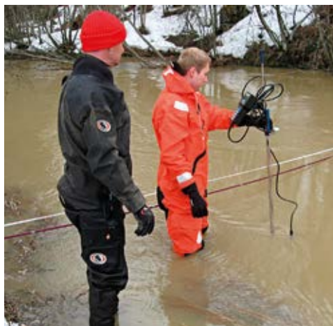
Ari Laukkanen Luode Consulting Oy:stä ja Mikko Brander Helsingin yliopistosta tekevät virtaamamittausta Palojoella FlowTracker-laitteistolla huhtikuussa 2012. Kuva: Anna-Liisa Kivimäki
