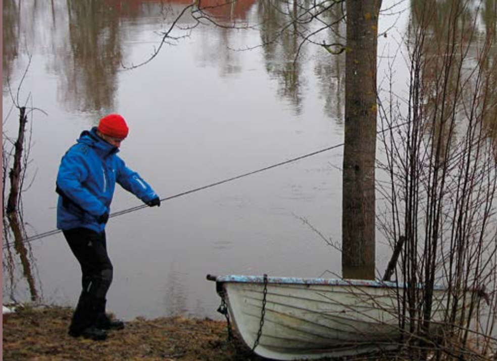
Ari Laukkanen Luode Consulting Oy:stä tekee virtaamamittausta Vantaanjoella RiverSurveyor M9 -laitteistolla huhtikuussa 2012. Kuva: Anna-Liisa Kivimäki
