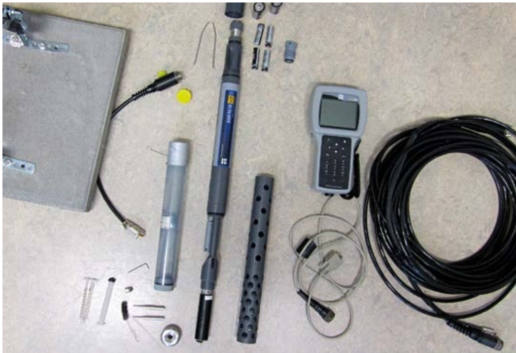
Anturit vaativat huoltoa ja teknistä osaamista laadukkaan mittausaineiston saamiseksi. Kuvassa VHSV:n YSI 600 XLM V2 anturi. Kuva: Pasi Valkama
