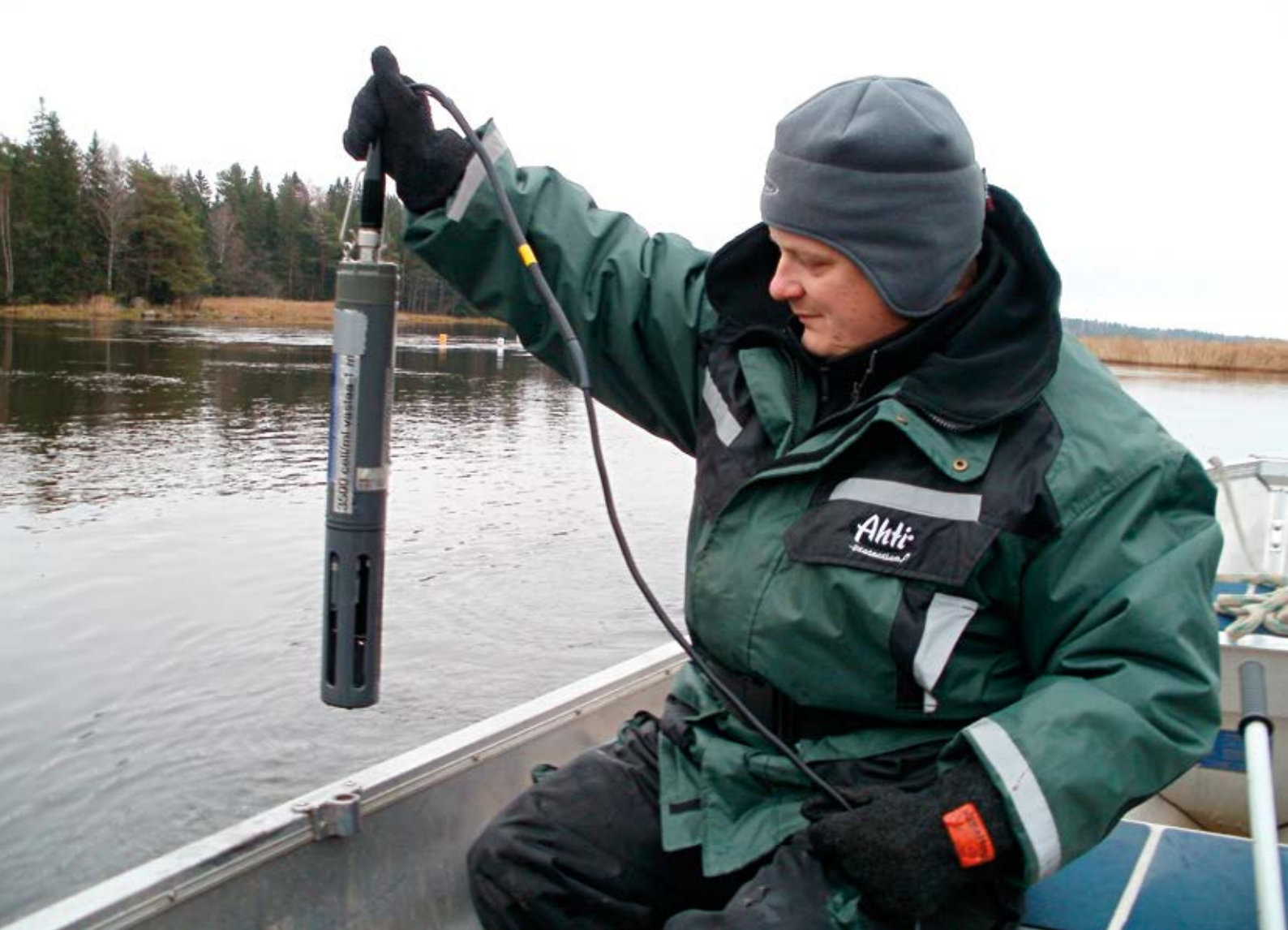
Kenttämestari Markku Kuisma tekemässä kartoitusta YSI-sondilla. Kuva: KYVY
