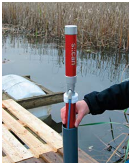
Automaattiset ravinneanturit mittaavat Hiidenvedeen tulevaa vedenlaatua 10 minuutin välein. Lisätietoja: http://maasaa.a-log.net/ Kuva: Sirpa Thessler, MTT
