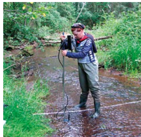
Anne Rautio Helsingin yliopistosta tekee virtaamamittausta Palojoella FlowTracker-laitteistolla elokuussa 2011. Kuva: Anna-Liisa Kivimäki
